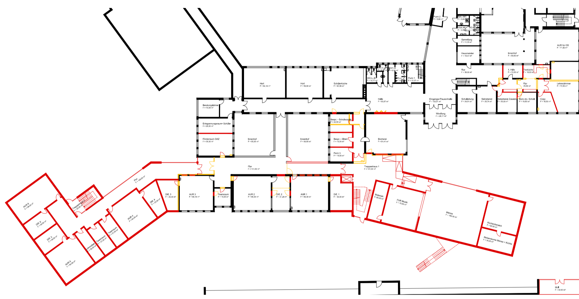
Grundriss Erdgeschoss | Bestand, Abbruch, Neubau
