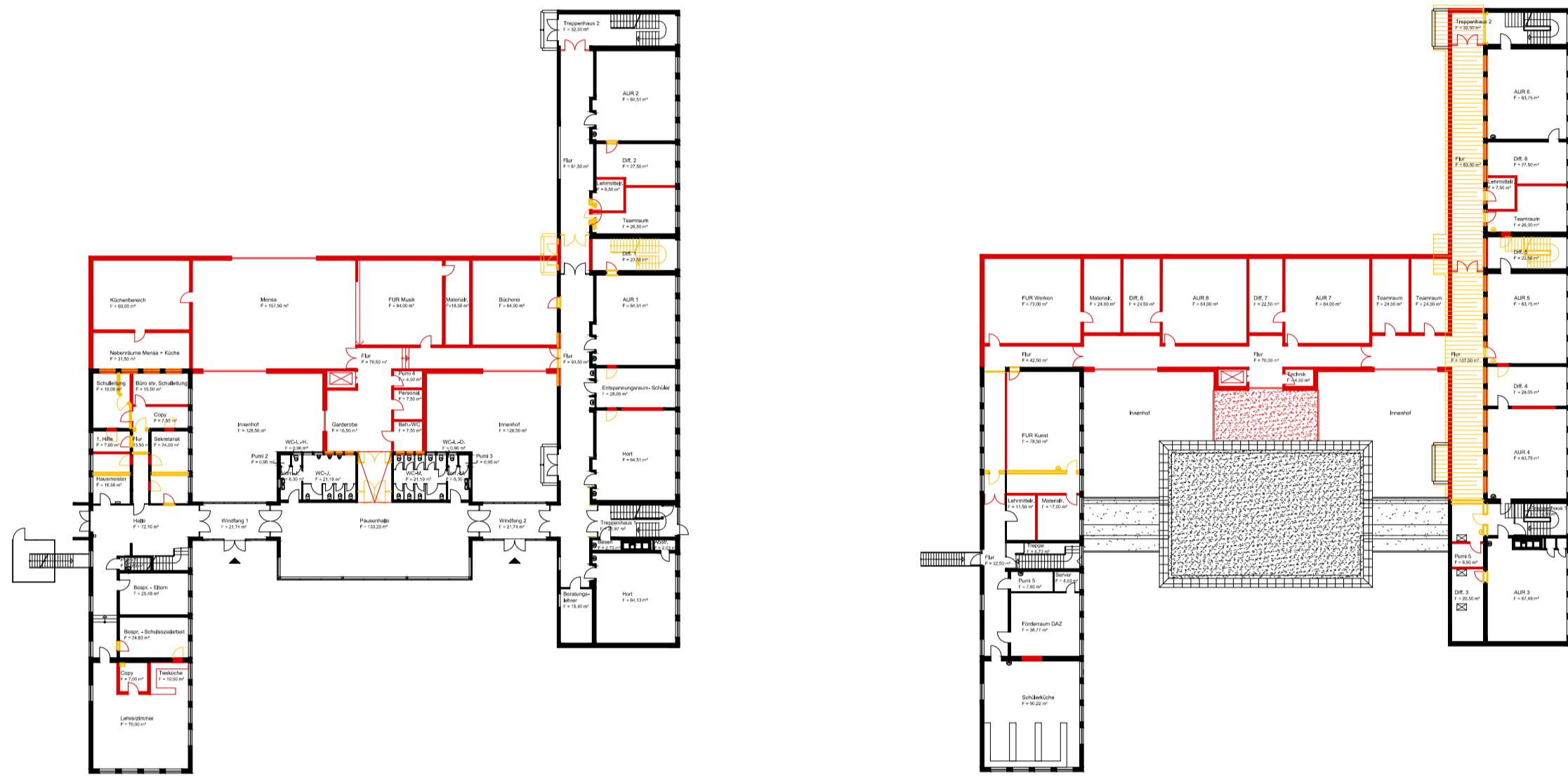
Grundriss Erdgeschoss | Bestand, Abbruch, Neubau
